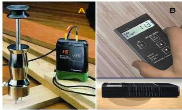
Figura 91 - Ilustrando os medidores elétricos de umidade da madeira. (A) Medidor do tipo resistência. (B) Medidor de contato.
