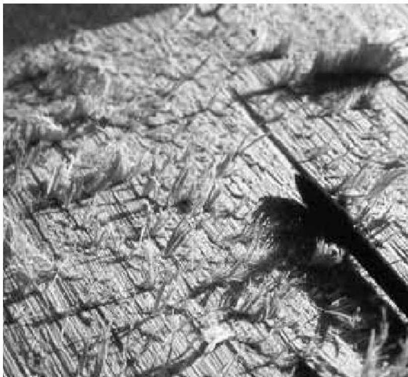
Figura 85 - Madeira de tração apresentando superfície felpuda após serragem.
