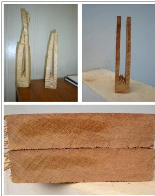
Figura 95 - Ilustrando o resultado do teste de tensões (à esquerda, madeira ainda tensionada; e à direita, madeira livre de tensões), e a presença de bolsas de umidade em madeira seca.
