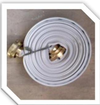
**Em espiral:** Tipo de acondicionamento utilizado para o armazenamento das mangueiras, devido ao fato de apresentarem dobras suaves, provocando menos desgastes no duto. Não é utilizada em operações de incêndios tendo em vista a demora em estendê-la e a inconveniência em lançá-la, o que pode causar avarias nas juntas de união.
