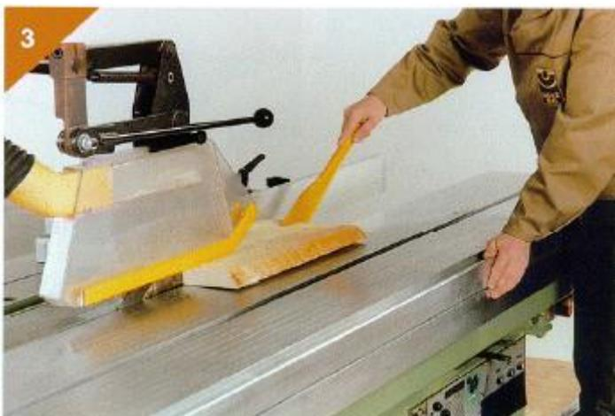
Para cortes inferiores a 30 mm utilizar tábua de apoio. Posicionar a guia paralela de tal forma que sua parte estreita encoste na peça a ser cortada.
