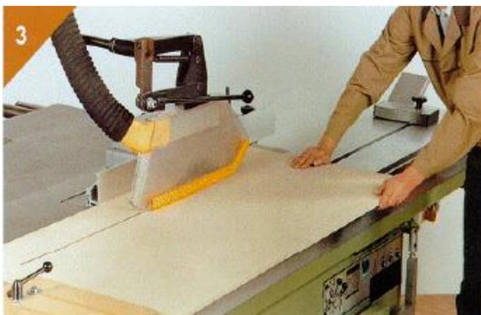
Após o corte baixar a lâmina da serra novamente, suspender a coifa, então retirar a peça.
