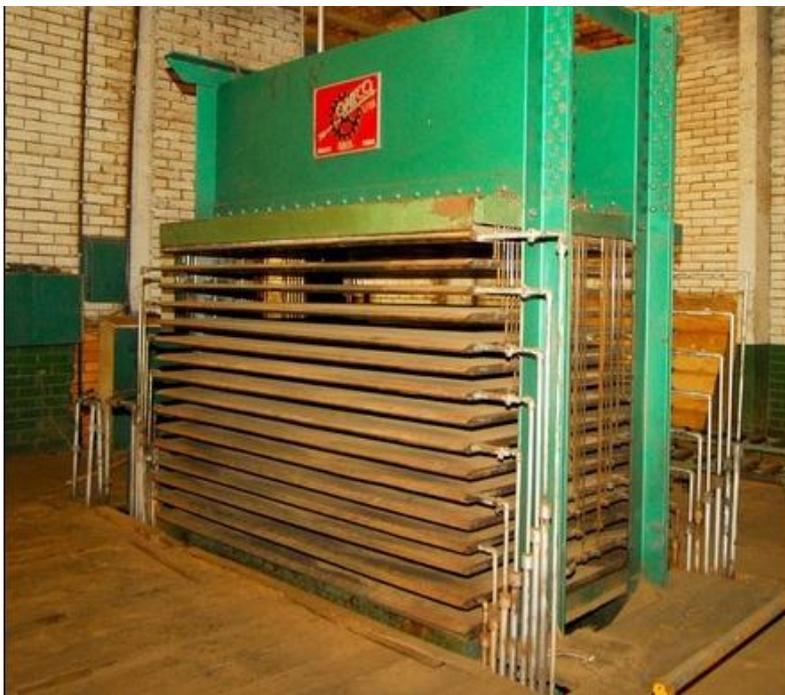
São utilizadas para revestir painéis (MDF, MDP, etc.) com laminas de madeiras, laminados plásticos, fórmica, etc.
