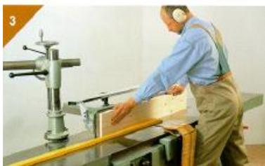
Não recuar a peça sobre o eixo porta facas desprotegido
