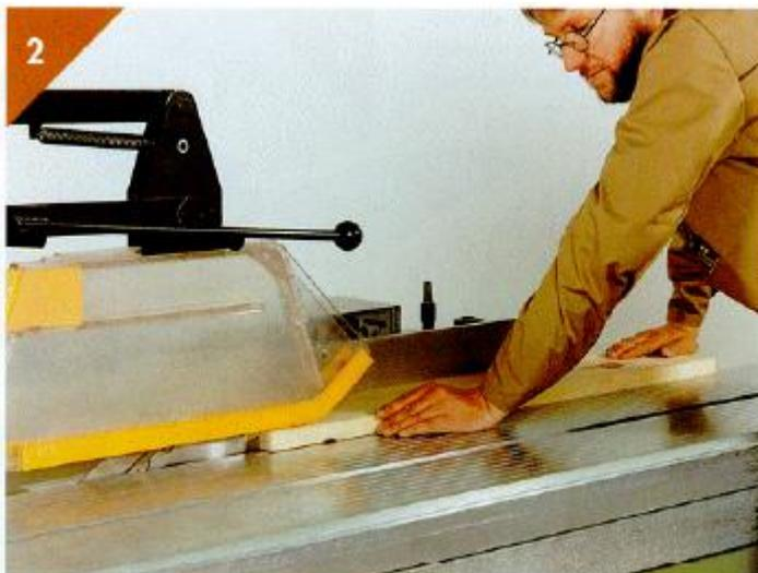
Para cortes inferiores a 120 mm é obrigatório utilizar sarrafo auxiliar ou tábua de apoio.
