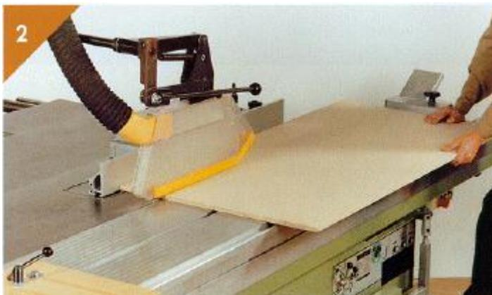
Suspender a lâmina da serra até a altura adequada, então empurrar a peça até o encosto posterior.
