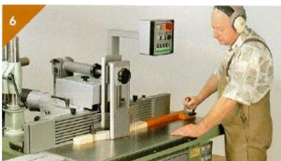
**Fresa transversal: 1** Para uma condução segura utiliza-se um dispositivo de proteção e pressão. Para peças compridas utilizar prolongador de mesa, para evitar giro da peça.
