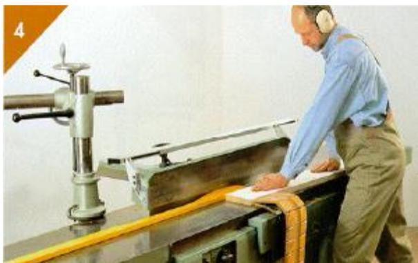
Nunca recuar a peça por sobre o eixo porta facas desprotegido.
