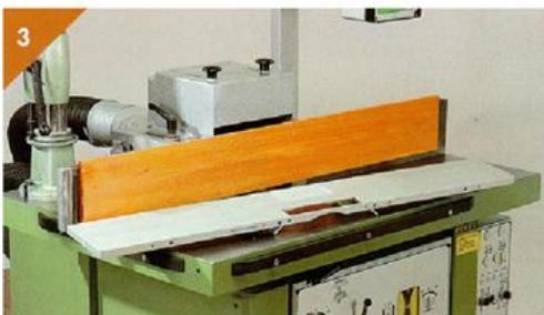
**Regulagem:** Manusear ferramentas, porcas do eixo porta ferramenta e anéis de distância, com cuidado. Nunca colocá-los diretamente sobre a mesa da máquina.
