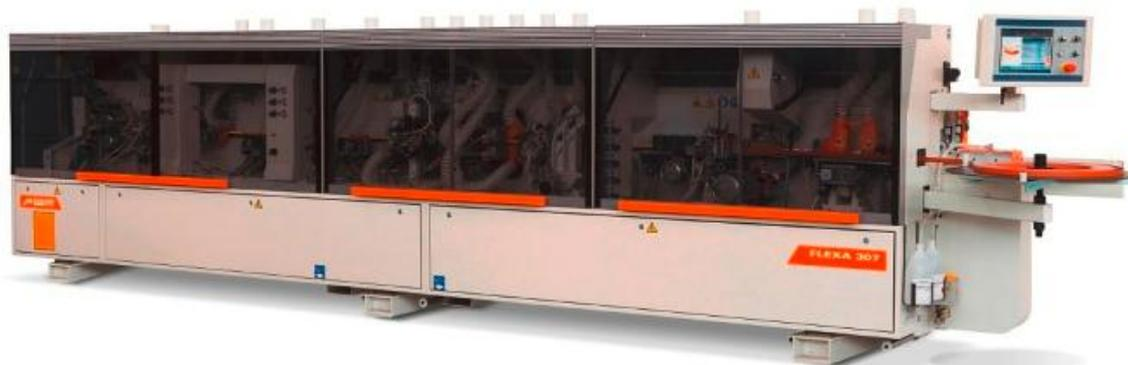
Coladeira de bordas automática com caixa de cola (coleiro) para colar com grande flexibilidade, material melâmínico, PVC e ABS até 3 mm e tiras até 5 mm.
