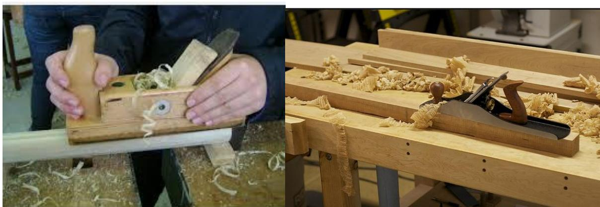
Justifica-se o comprimento dessa ferramenta por sua função de retificar, quando desliza sobre a superfície ondulada. Isto porque o gume do ferro é capaz de cortar a madeira de ondulação mais elevada.
