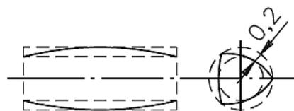
A circularidade é um caso particular de cilindridade, quando se considera uma seção do cilindro perpendicular à sua geratriz.
