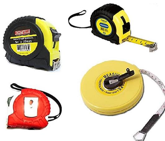
A fita das trenas de bolso são de aço fosfatizado ou esmaltado e apresentam largura de 12,7 mm e comprimento entre 2 m e 5 m. Quanto à geometria, as fitas das trenas podem ser planas ou curvas. As de geometria plana permitem medir perímetros de cilindros, por exemplo.
