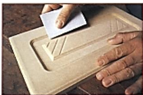
lixe previamente as regiões usinadas com lixa grana 220/280
