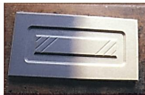
aplique uma demão de fundo, deixe secar e lixe com lixa grana 320/360
